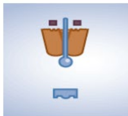
EFO打火杆在磁嘴前烧球
