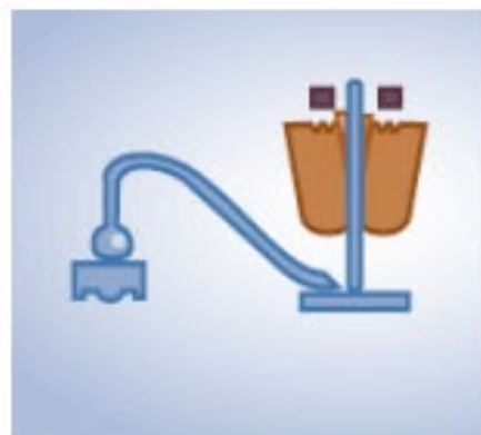
Cap侧向划开，将金线切断，形成鱼尾
